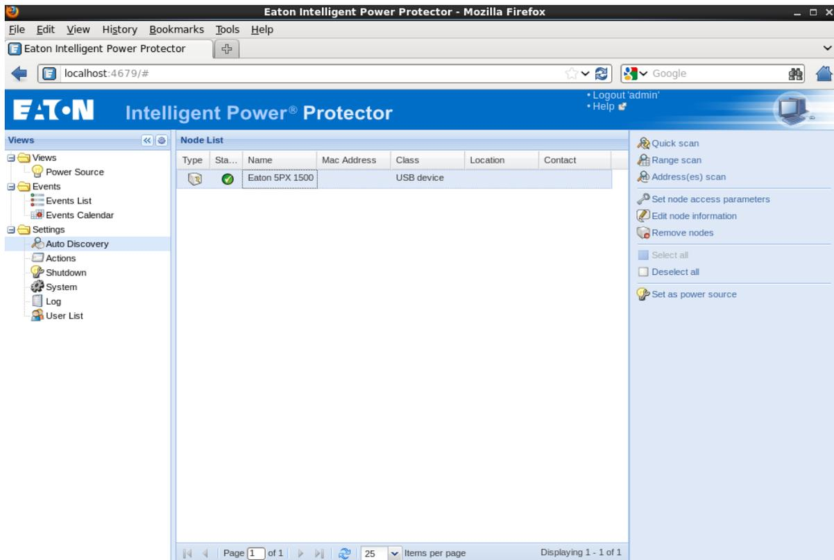
左側ツリーの Auto Discovery の項目をクリックすると Intelligent Power Protector が認識している Eaton UPS が表示されます。接続した Eaton UPS が表示されない場合は、右上の "Quick Scan" をクリックして Eaton UPS を再認識させてください。
