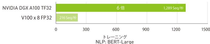
フェーズ 1 (2/3) とフェーズ 2 (1/3) から成る PyTorch を使用した BERT 事前トレーニング性能 | フェーズ 1 シーケンス長 = 128, フェーズ 2 シーケンス長 = 512 | V100: 8 基の V100 を搭載した DGX-1, FP32 精度を使用 | DGX A100: 8 基の A100 を搭載した DGX A100, TF32 精度を使用
