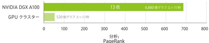
3,000 台の CPU サーバーと 4 台の DGX A100 の比較 | 公開されている Common Crawl データセット: 128 B エッジ, 2.6 TB グラフ
