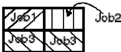
(c) 午前 8 時 30 分に Job3 を投入。 Job3 が Job2 をバックフィル。
