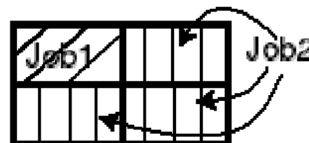
(b) Job2 は投入されたが、プロセッサ が 4 つ必要なため開始できない。 残りの 3 つは Job2 により 予約される。
